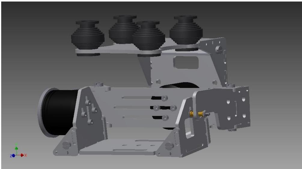
Den Einsatz des Bundlagers in den Wippenarm-rechts führen Sie bitte mit leichtem Druck aus, evtl. müssen Sie die Bohrung noch mit einer kleinen Rundfeile passend machen. Das Lager sollte sich leicht eindrücken lassen. Die Kunststoff Schrauben verwenden Sie bitte für die Verschraubung der Carbon Teile, die Metall Schrauben für die Montage der Motoren.
